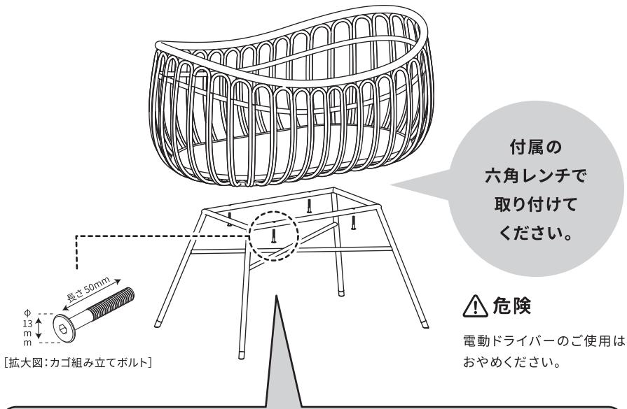
カゴと脚のフレームの穴位置を合わせてからカゴ組み立てボルトで固定してください。
